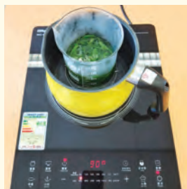
加入乙醇和水，再用電磁爐隔水加熱
