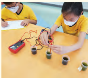
取出 50mL 葉綠素液，以鋅片和銅片作為正負極，用萬用電錶測量電壓與電流。
