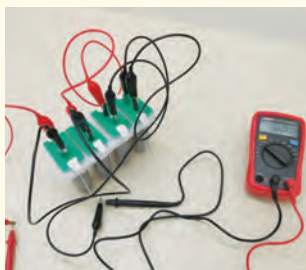
串聯 4 格葉綠素電池，連接萬用電錶測量電壓與電流
