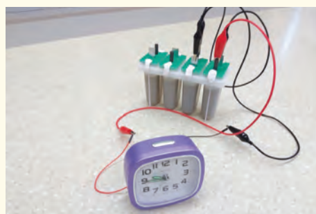
串聯 2 格葉綠素電池——時鐘可運轉
