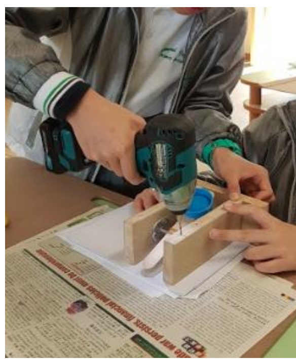
相片 7：(左)沙紙打磨經切割的回收木塊 (右)利用電動工具把螺絲鑽入木塊組件
